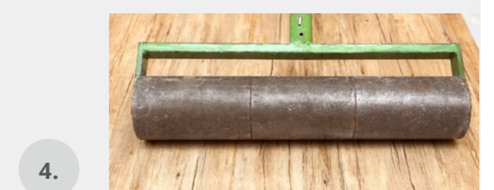
Zaválcování položené plochy / Rolling laid surfaces / Einwalzen einer verlegten Fläche / Прокатка уложенного покрытия / Roulage de la surface posée
